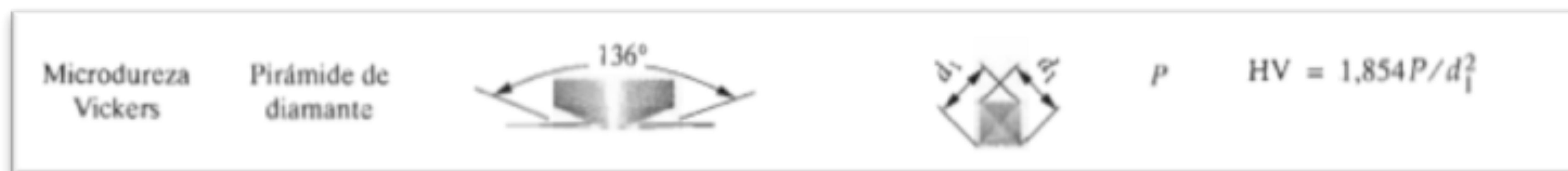
Figura 5. Técnica de ensayo de dureza (10).
