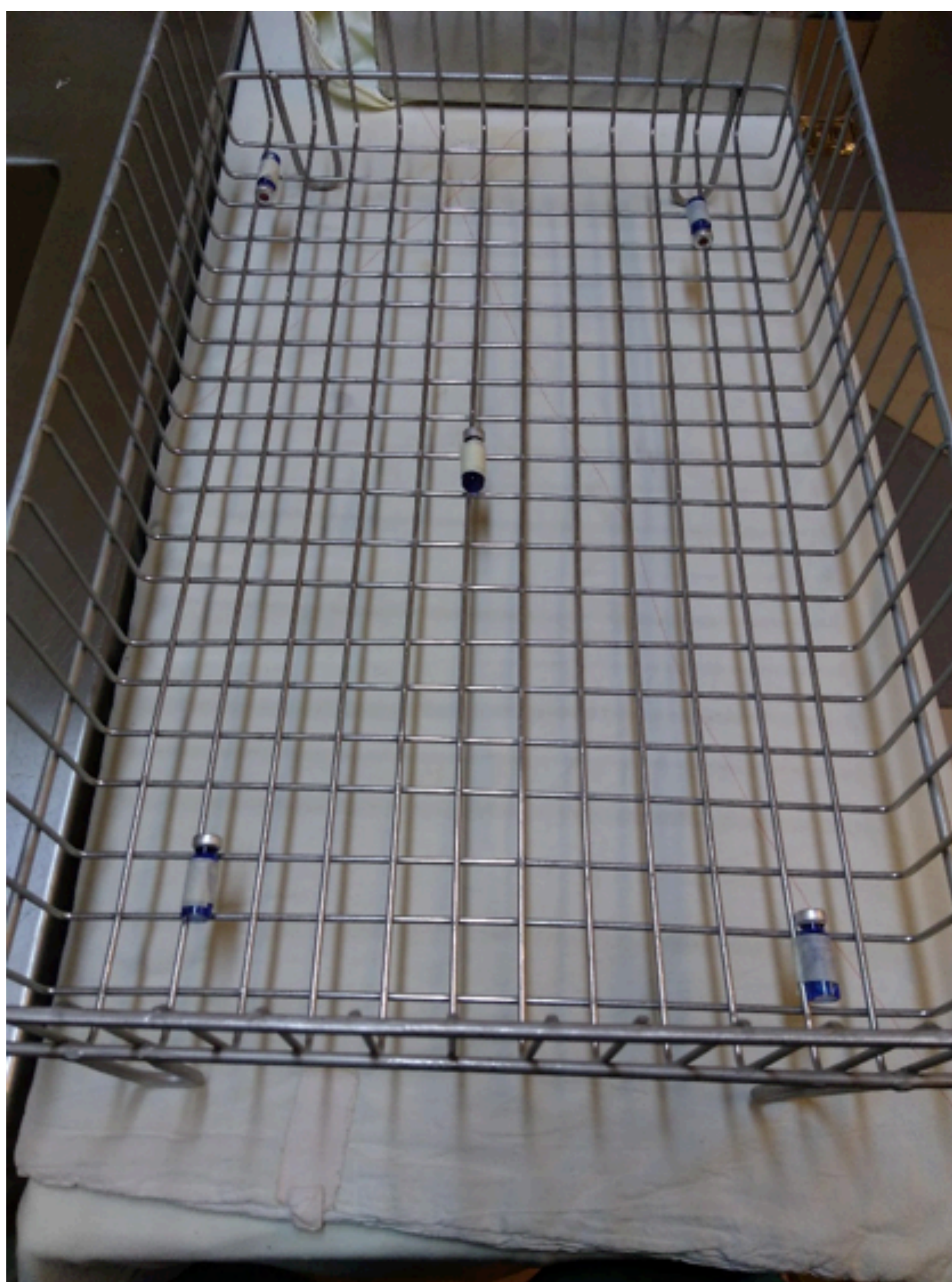
Controles CDWA colocados en el canasto, previo a ser colocados en la bacha de lavado
